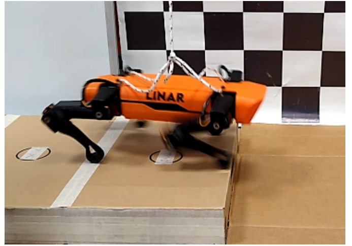
Figura 6: Setup experimental, escalón de altura variable que permite variar la dificultad de la prueba de manera simple
